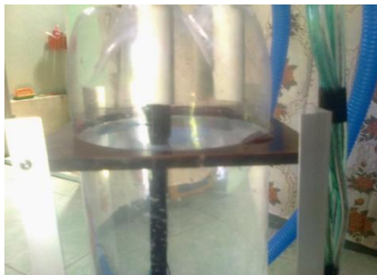
Gambar 12. Tandon Terdeteksi Level 3 Sebagai Batas Atas Pada Tandon
