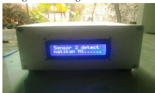
Gambar 11. Indikator Sensor Level 2 Terdeteksi Dan Motor Pompa 1 OFF
