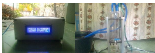
Gambar 6. Simulasi Pengujian Tandon Dalam Keadaan Kosong
