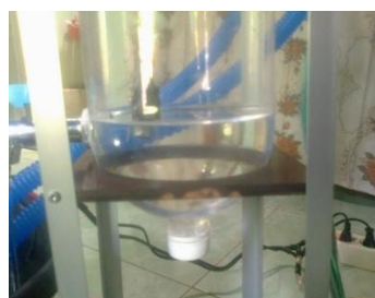
Gambar 8. Tandon Terdeteksi Level 1 Sebagai Batas Bawah Pada Tandon
