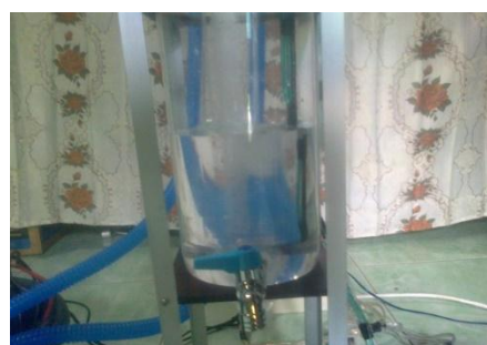
Gambar 10. Tandon Terdeteksi Level 2 Sebagai Batas Tengah Pada Tandon
