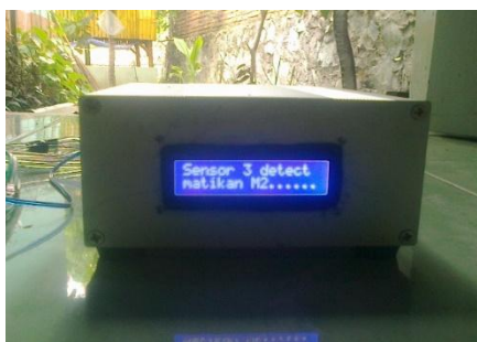
Gambar 13. Indikator Sensor Level 3 Terdeteksi Dan Motor Pompa 2 OFF
