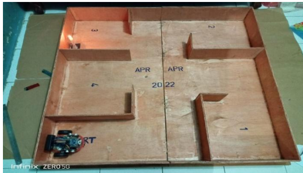
Gambar 19. Pengujian Robot Dengan 1 Titik Api
